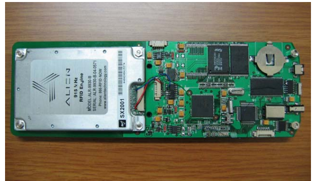
그림 4 이동형 uID Reader Platform의 내부
